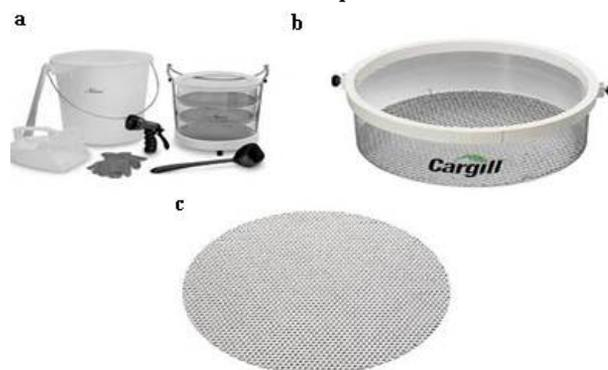
**Imagen 1.** a: Equipo comercial Nasco Digestion Analyzer completo con todos los utensilios; b: se muestra con mayor detalle la bandeja donde queda el material retenido y c: tamiz de acero cada uno con su respectivo tamaño de poro.
